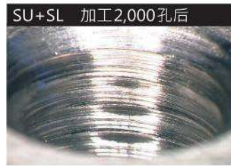
进刀处表面粗糙度 Ra=1,1μm
